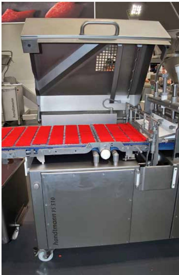
Obr. č. 1: Formovací zařízení Handtmann FS 510 s 24 proudým děličem toku a přímým ukládáním na síta
